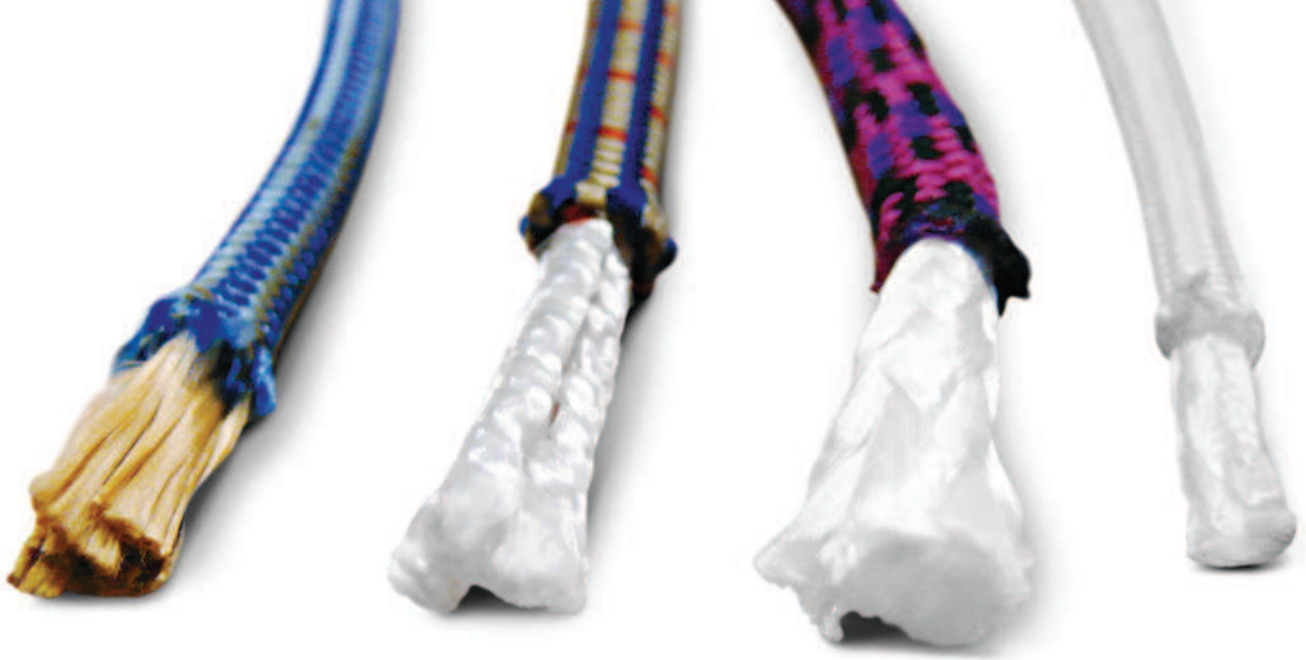
v.l.n.r.: Kevlar-Reepschnur mit PA-Mantel, Polyamid-Reepschnur (Kern und Mantel aus PA), Dyneema-Reepschnur mit PA Mantel und ganz rechts eine reine Dyneema-Reepschnur (Kern und Mantel aus PE) Foto: Chris Semmel
