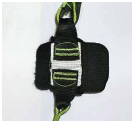
Abb. 4: Sicherheits-Check am Bandfalldämpfer: Alle Nähte müssen intakt sein ...
