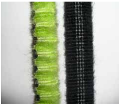
Abb. 3: Deutliches „Aufpelzen“ von textilem Material – ein Grund, das Set auszutauschern.
