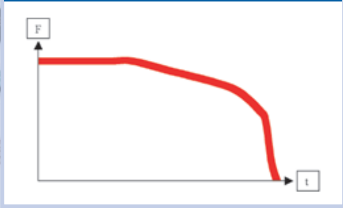
Abb. 4: Festigkeitsabnahme durch UV-Belastung. Die Haltbarkeit ist abhängig von der Intensität der UV-Belastung.
