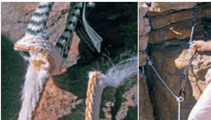
Abb. 1 und 2: Die „Unfall“-Schlinge vor Ort und die Fixseilaufhängung in Reihenschaltung für den Abseilvorgang.
