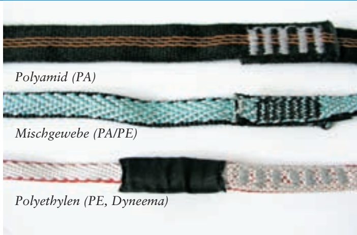
Abb. 3: Verschiedene Schlauchbandmaterialien, unten die Spezialvernähung für eine hohe Nahtfestigkeit.
