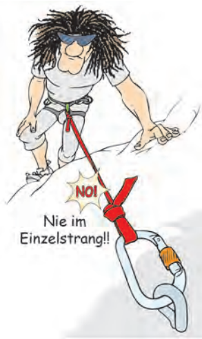
Abb. 3: Bandmaterial im Einzelstrang wird durch Knoten gefährlich geschwächt.
