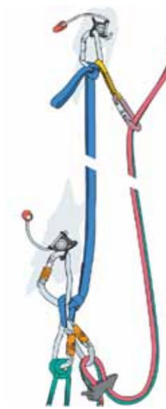
Bei permanenter Führung Verbindung der Schrauben mit Standplatzschlinge
